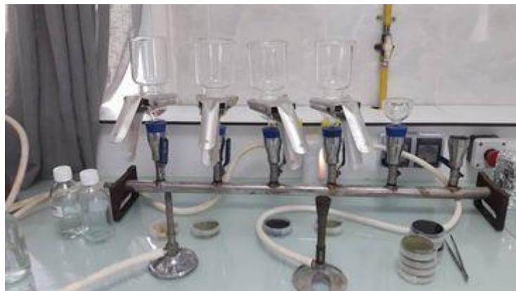
Figure 4 : Rampe de filtration
