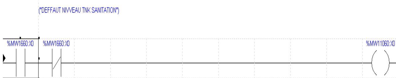
Figure4.27. défaut de niveau TNK sanitation.
