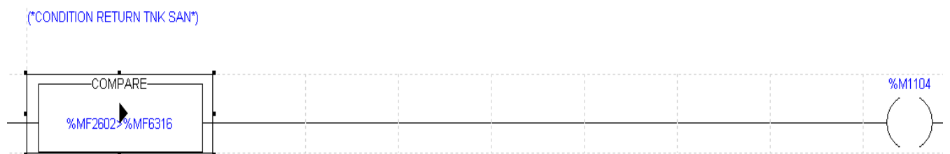
Figure 4.20. Condition de retour dans la cuve de sanitation.
