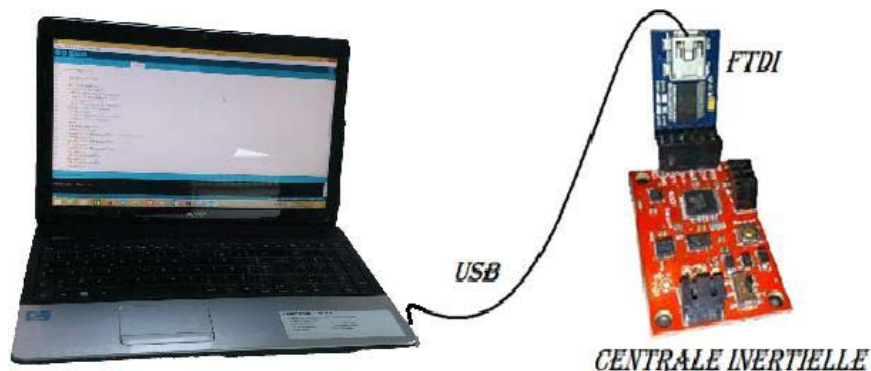
Figure IV-13 : Branchement PC - FTDI - Razor IMU
