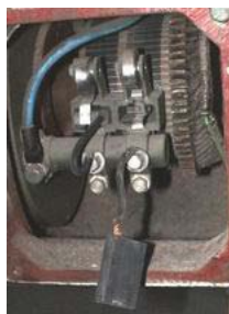
Figure II-3 : L'ensemble balais, porte-balais et collecteur [4]
