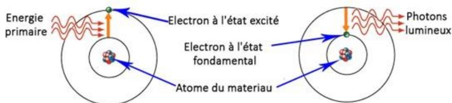
**Figure 1.4.** Processus d'émission d'un photon lumineux.
