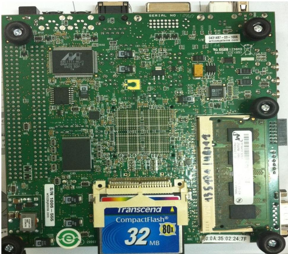
Figure 4.4. Plateforme de développement Virtex-5 (vu de dessous).
