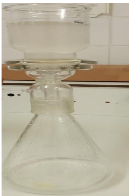
Annexe 04 : Dispositif de filtration
