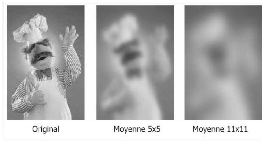
Figure 1.12. Application du filtre moyenneur sur une image.
