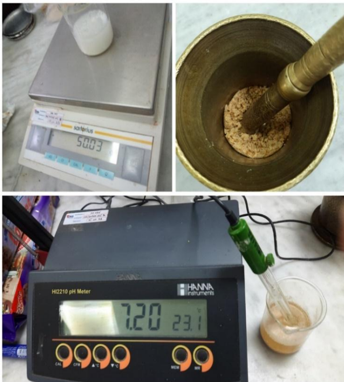
L'analyse de ph pour la matières premières et produit fini « Frine », « Quinoa », « Biscuit ».
