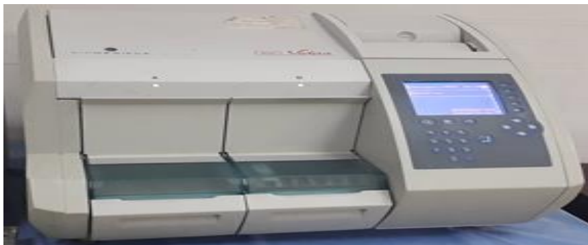
Figure 16 : Automate mini vidas utilisée pour le bilan hormonal
