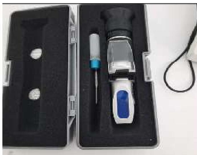
**Réfractomètre (Brix 0-90%) à T<sub>R</sub>=20°C**
