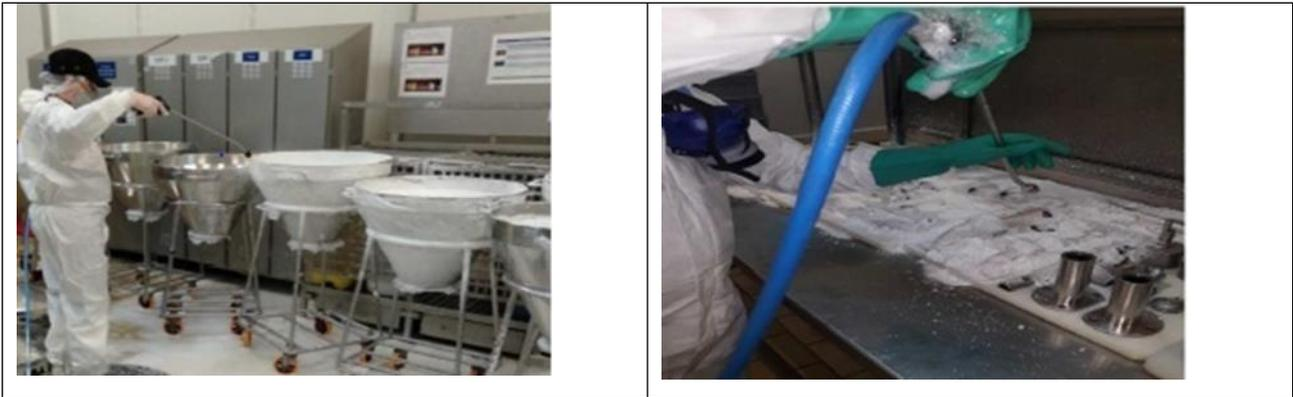
**Figure n° 10 :** Application de la solution enzymatique à l'aide de canon à mousse
