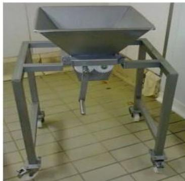
**Figure n° 6 :** Broyeur de fromage de fonte (emmental, cheddar ...) (original)
