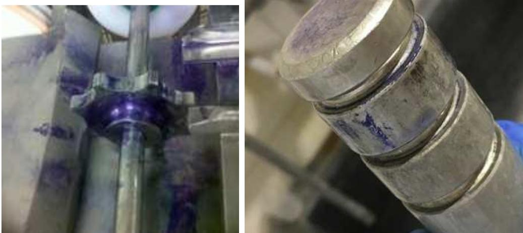
**Figure n° 8 :** Révélation de biofilm sur des pièces de coulée
