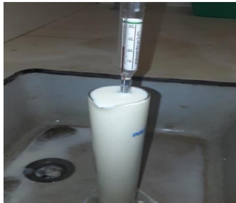
Figure n°07 : Mesure de la densité du lait entier UHT par lactodensimètre (Originale).
