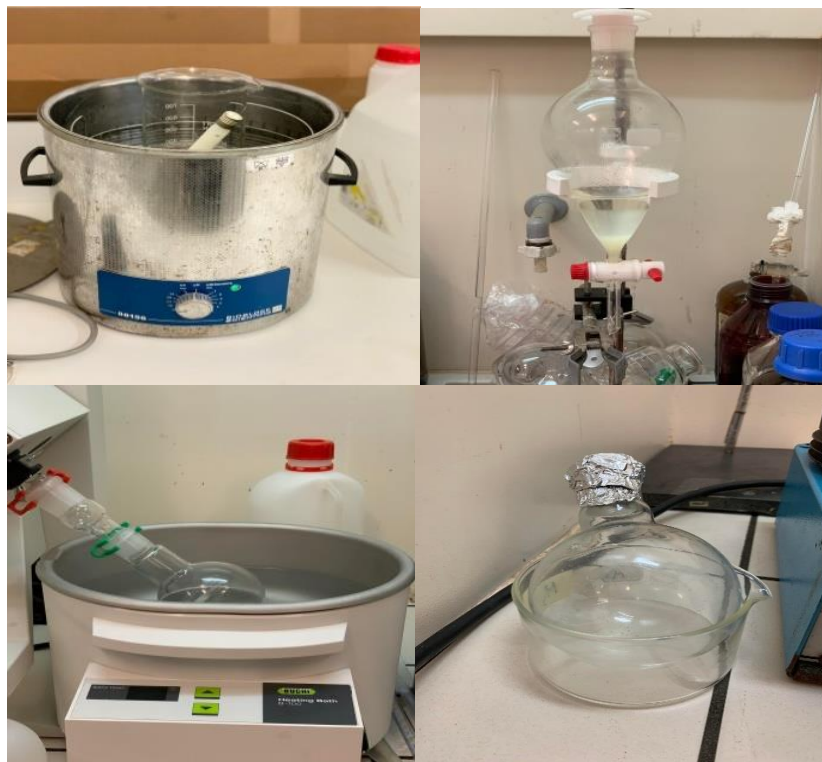
Figure n°11 : Les différentes étapes de l'extraction de la matière grasse du lait par la méthode Rose-Gottlieb (Originale).
