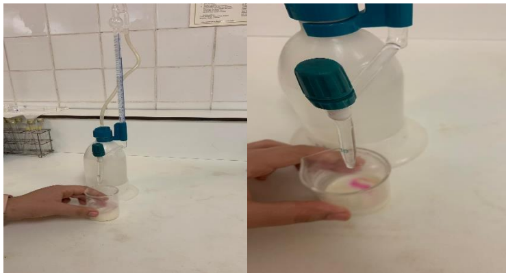
Figure n°09 : Mesure de l'acidité titrable en °D du lait (Originale).
