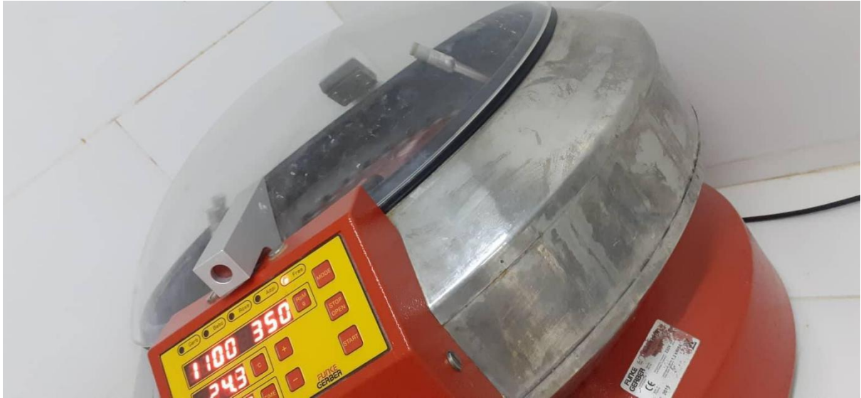
Figure 27 : Centrifugeuse des butyromètres
