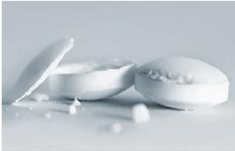
Figure 06 : Phénomène de décalottage du comprimé (Scientist live, 2020)
