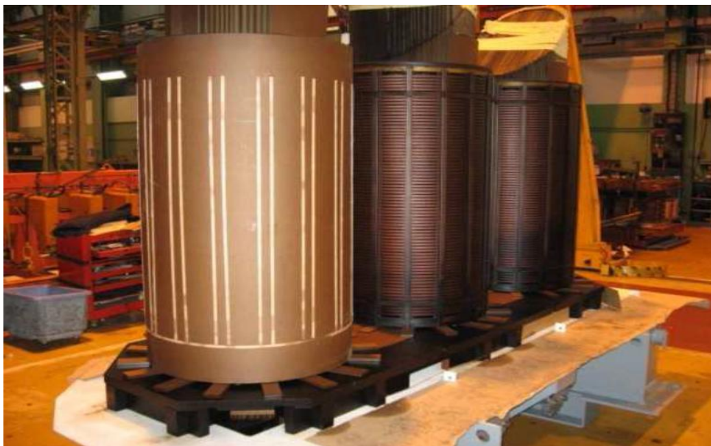
Figure 1-7 Circuit à colonne.
