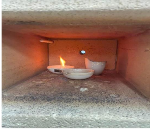
Figure 17. Four à Moufle à 600C° Figure 18. Les cendres obtenues
