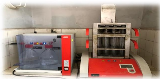
Figure (26) : Matras Kjedahl l'unité de minéralisation à 400°C (photographie originale)
