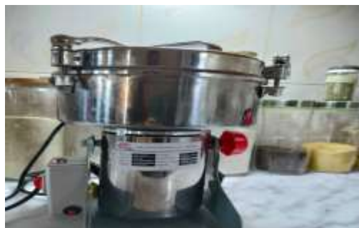
Figure n°11 : broyeurs utilisés pour la mouture de blé tendre. Photo originale
