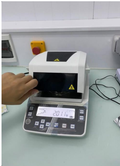
Figure 34. L'appareil qui mesure la matière sèche
