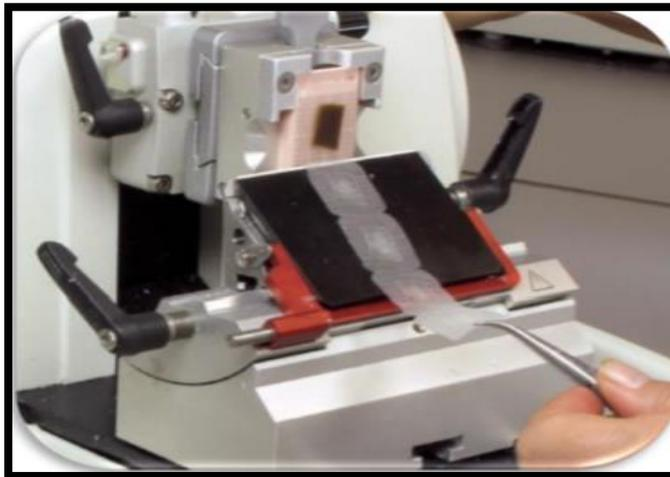
**Figure 9.** Obtention des coupes sous forme d'un ruban.
