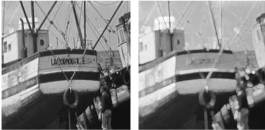
Figure 3.6 Exemple simple d'une dilatation numérique.
