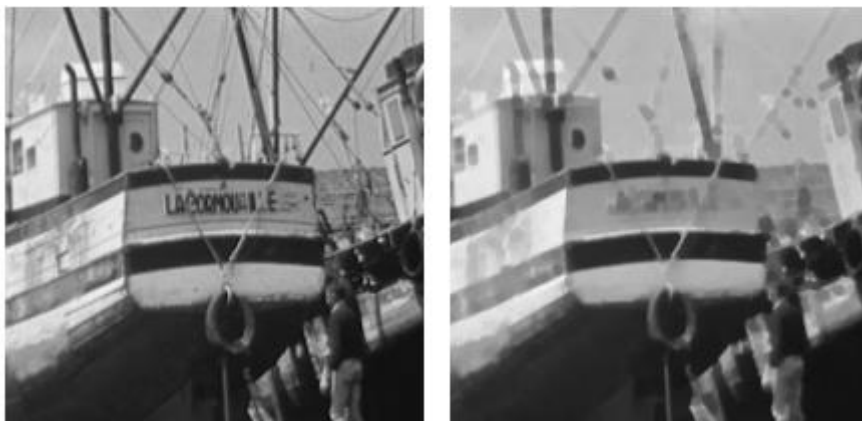
Figure 3.9 Exemple simple d'une fermeture numérique. a : Image initiale b: Fermeture de l'image initiale par un disque de taille 3
