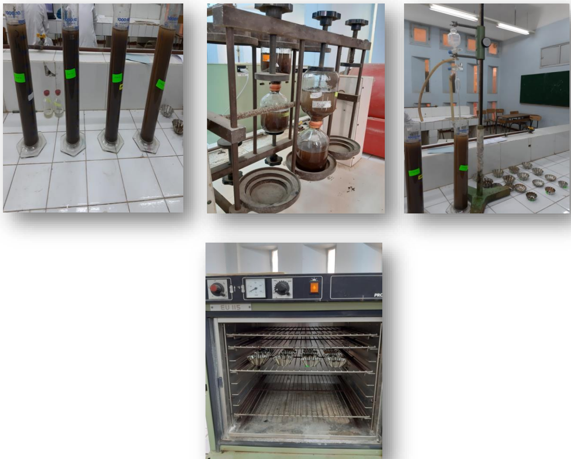
Figure 27 : Etapes de l'analyse granulométrique au laboratoire (Original 2021).
