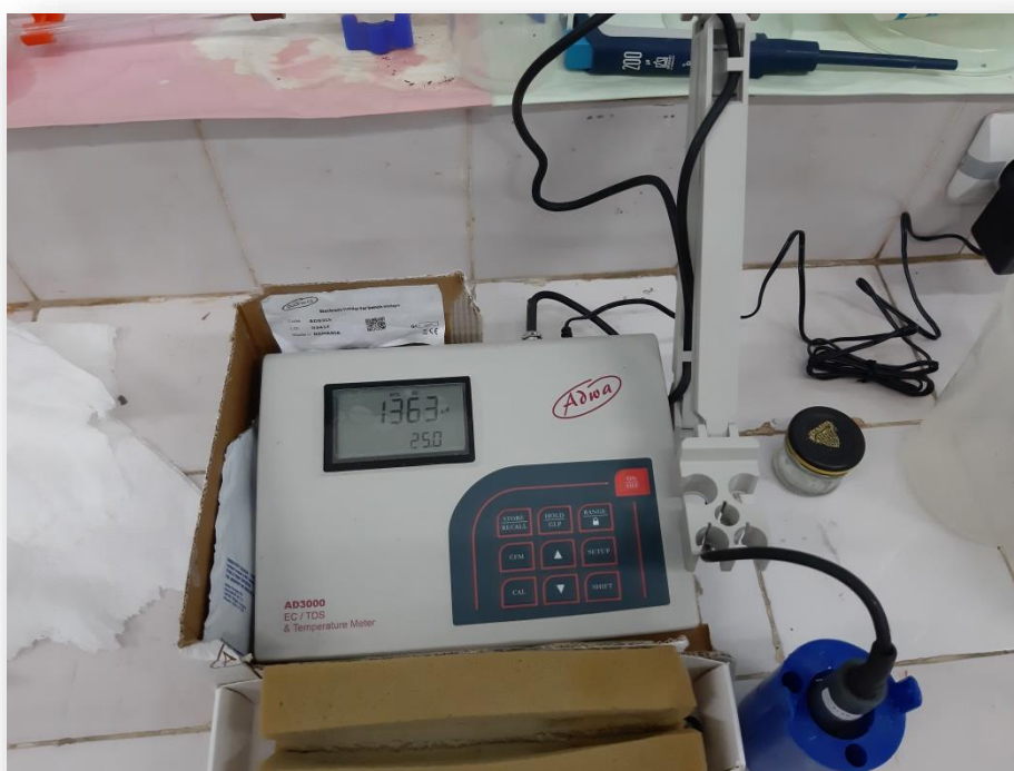
Figure 26 : Le conductimètre pour mesurer la conductivité (Photo original 2021).
