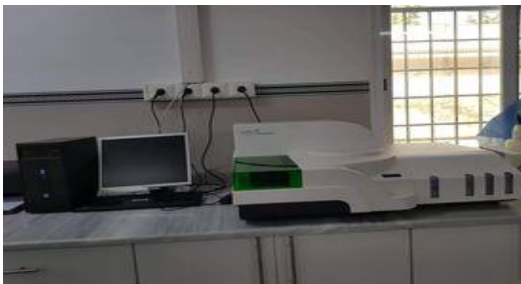
Figure 9 : Automate SEBIA CAPILLARYS 2 FLEX PIERCING Au niveau de laboratoire central C.A.C Blida (photo originale).
