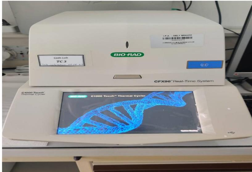
**Figure 15.** Thermocycleur BIO-RAD CFX96 utilisé pour la réaction de la RT-PCR en temps réel.
