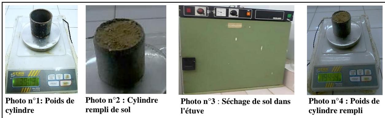
**Figure n°15 : Protocole expérimental de la densité apparente (Originale, 2021)**
