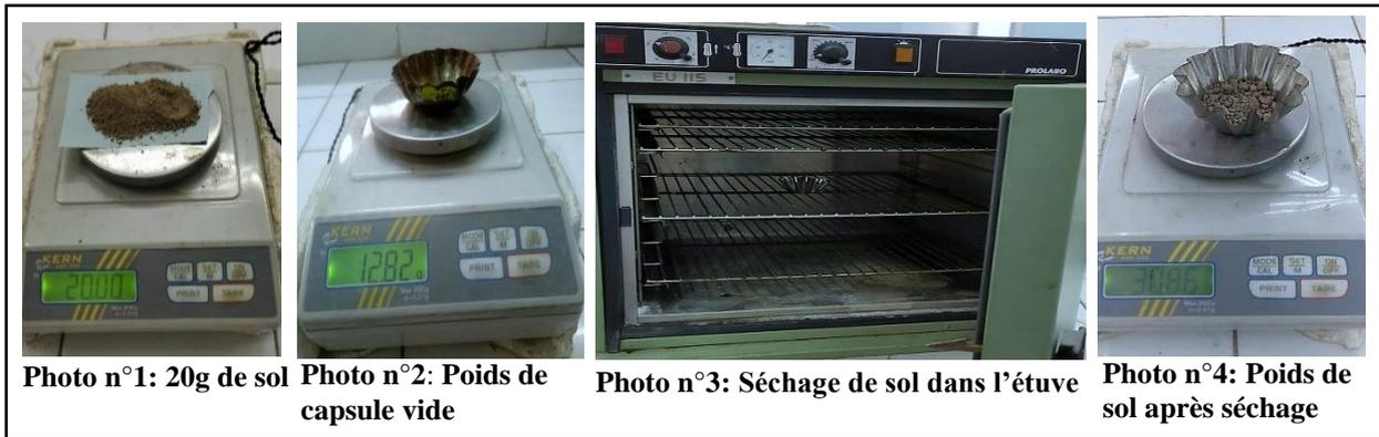
**Figure n°12 : Protocole expérimental de l'humidité (Originale, 2021)**
