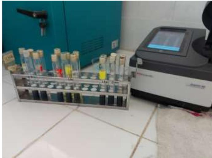
**Figure II.4: Mesure de l'absorbance des solutions de miels (Originelle, 2021)**
