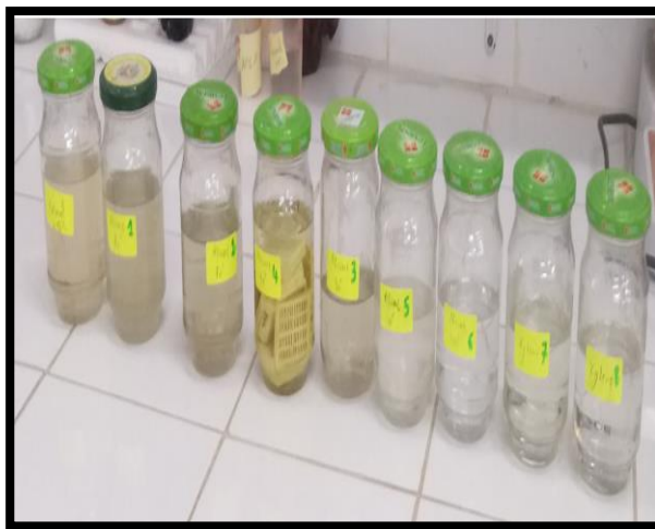
Figure 13 : Batterie de déshydratation.
