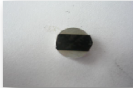
Figure 65: Scotch carbone ( en noir ) pour la fixation des objets
