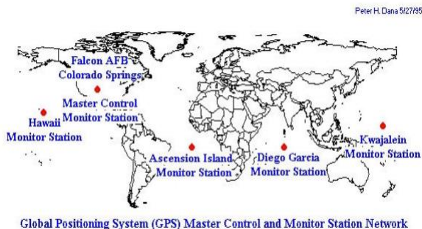
Figure 1.10. Localisation du segment terrestre[13].
