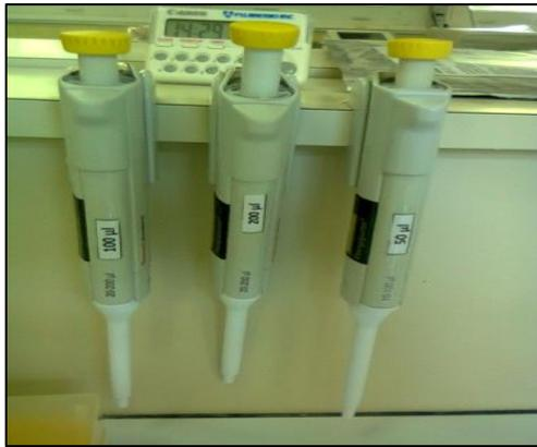
Figure 30 : Micropipettes à volume fixe de 50µl,100µl,200µl
