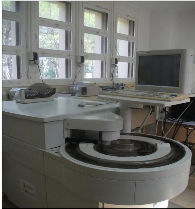
**Figure 11 : Automate de sérologie AxSYM ABBOTT**
