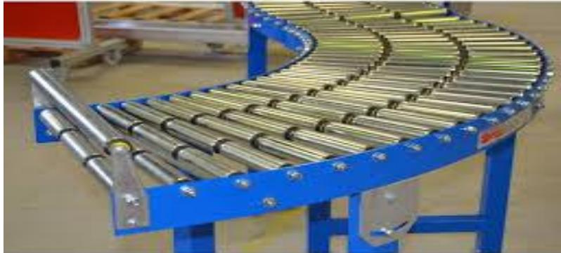
Figure 1.9 : Convoyeur à rouleaux
