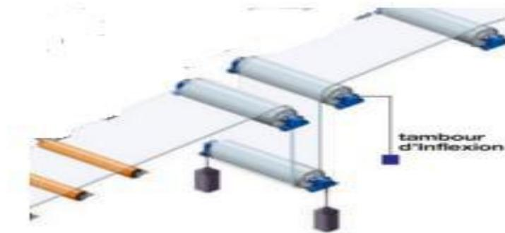
Figure 2.8 : Tambour d'inflexion d'un convoyeur à bande
