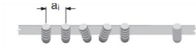
Figure (3.6) L'écartement minimal entre les stations suspendues.
