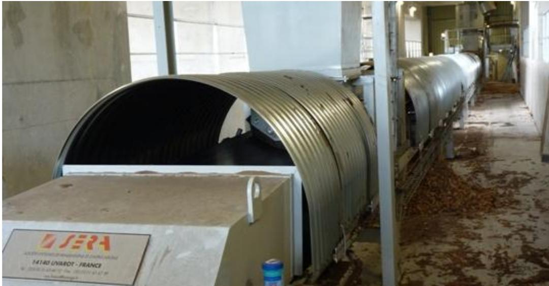
Figure 2.15 : Capots pour convoyeur
