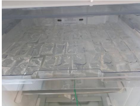
Figure 34. Photo d'emplacemnt de MCP dans le baquet supérieur de compartiment réfrigérateur.
