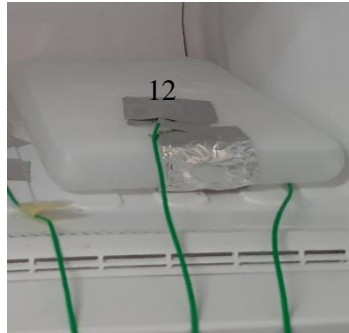
Figure 39. Photo des thermocouples placés dans les MCP.
