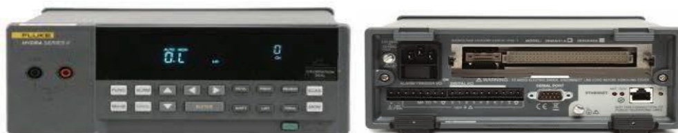
Figure 24. Photos du Data Logger type Hydra 2700 face avant et arrière.
