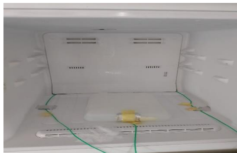
Figure 33 .Photo de l'emplacement de MCP dans le congélateur.
