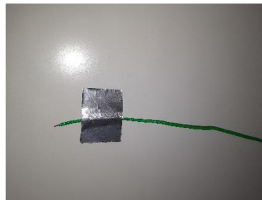
Figure 38. Photo de thermocouple placée dans l'ambiante.
