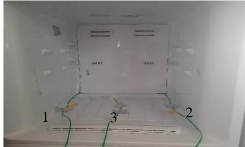
Figure 37. Photo des thermocouples placés dans le congélateur.
