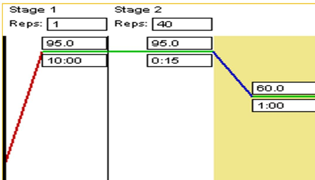
**Figure 17 : Protocole de travail du logiciel du thermocycleur 7500 ABI.**
