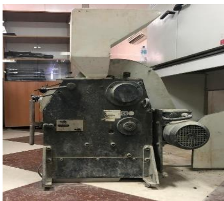
Figure III.3. Concasseur de matériaux
