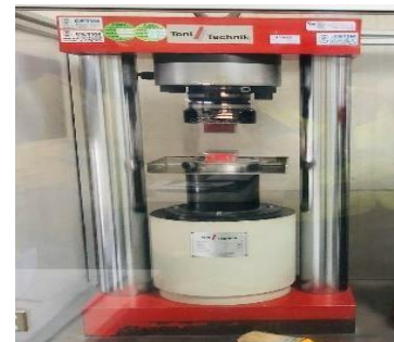
Figure III.12. Test Résistance à la compression
