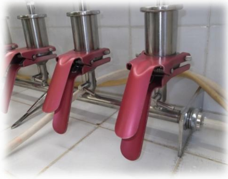
Rampe de filtration
