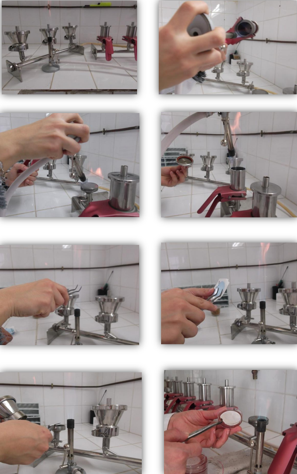
Figure 10: Principe de la technique de filtration sur membrane (Photos originales).
