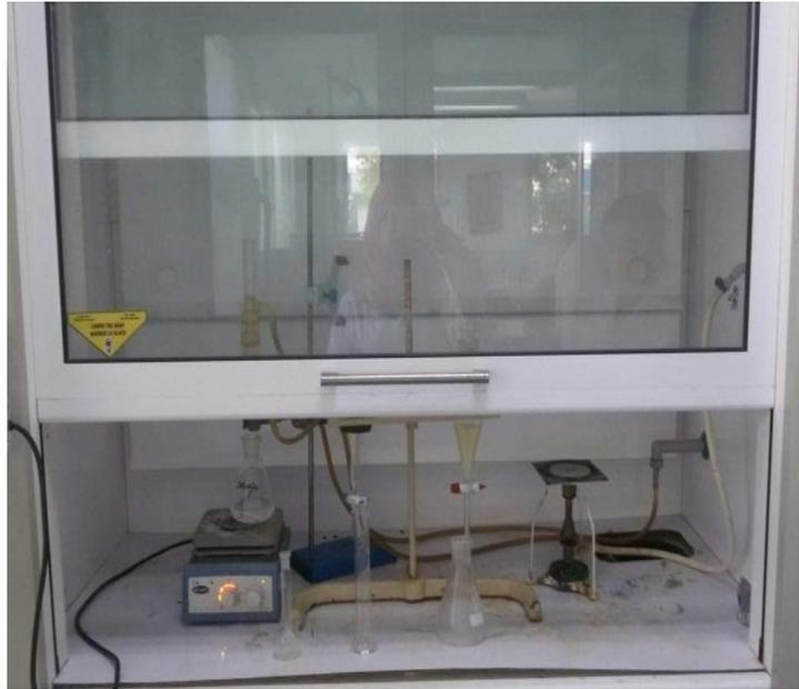
**Figure 16 :** Hotte à flux laminaire
