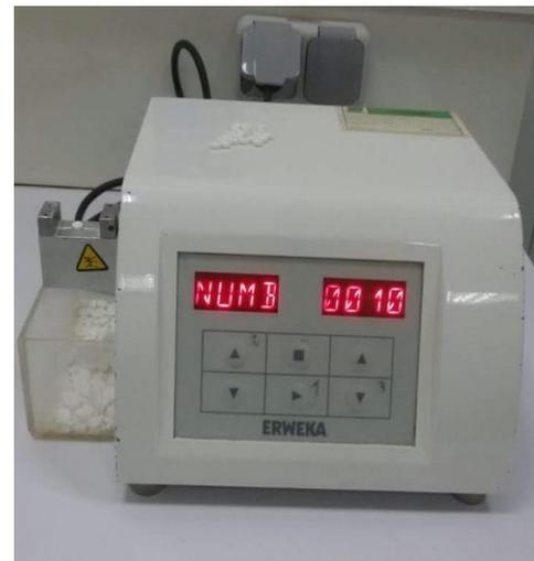
Figure 4 : Duromètre
