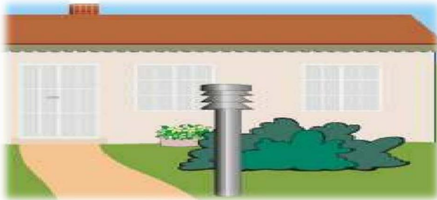
figure33: Schéma représentatif de la prise d'entrée de l'air neuf (source:pdf_src_guide.des.puits.canadiens_cetiat_2008)
