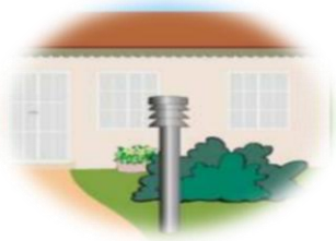
Une entrée d'air neuf
