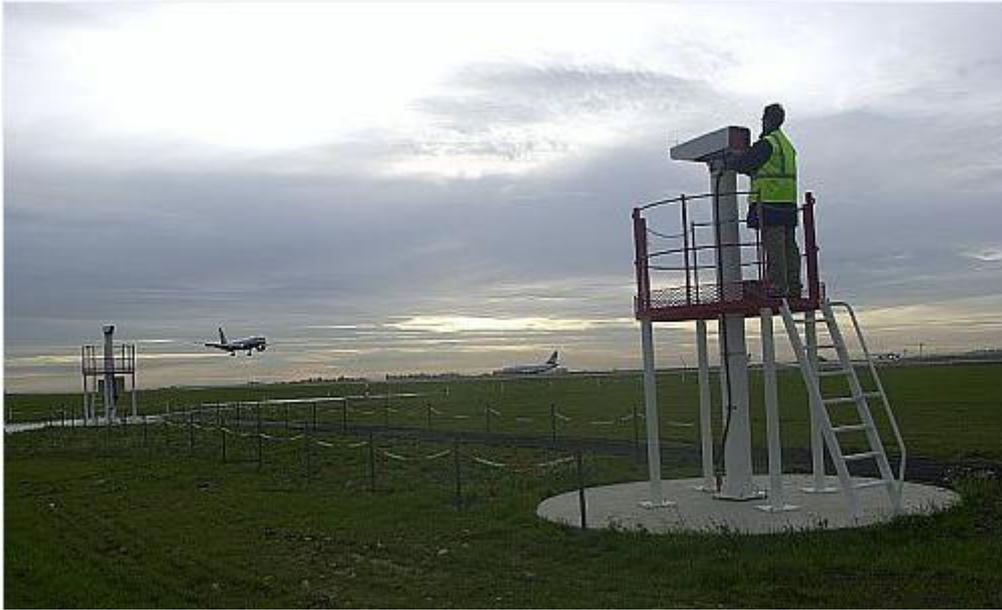
**Figure I.3.** : Le transmissomètre [11].
