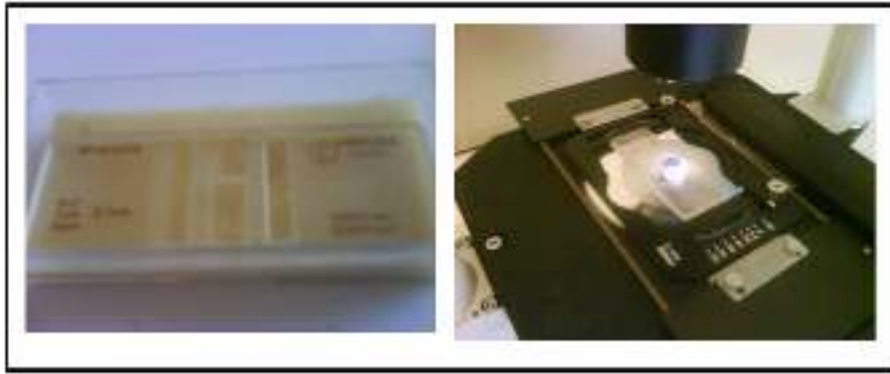
Figure 15 : la cellule NEUBAUER et comptage cellulaire sous un microscope inversé (Photo originale)
