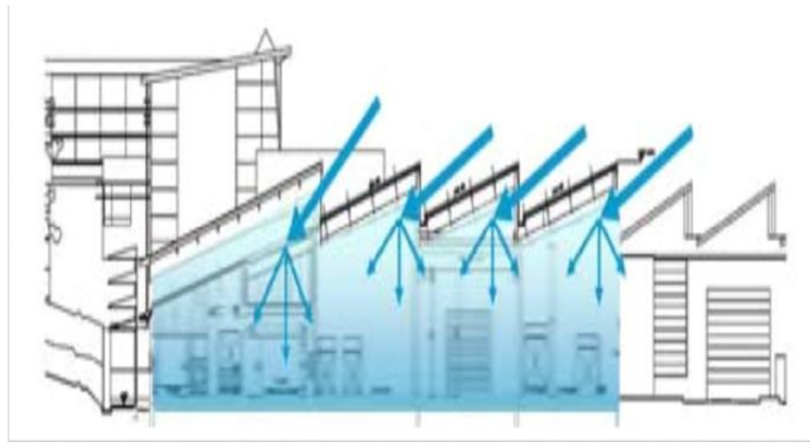
Figure 27: le principe des sheds. (source : http://www.energieplus-lesite.be )
