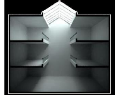
Figure 24: Performances lumineuses du puits de jour. (source : http://theses.ulaval.ca )
