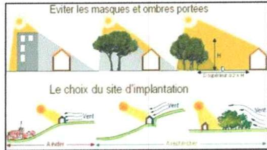
Figure 01 : Confort thermique selon l'orientation.
