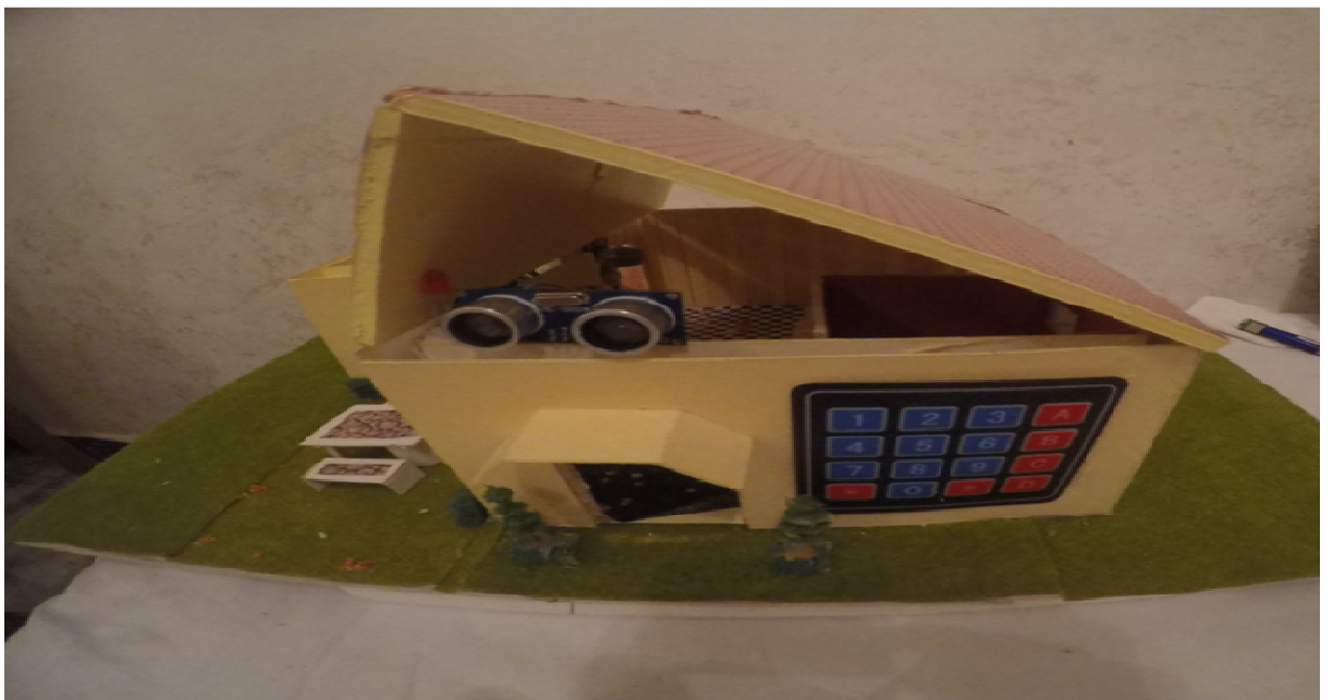
Annexe 4 : montage pour mesurer la distance
