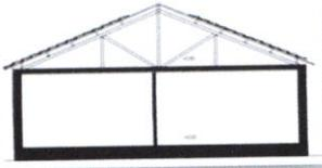
système de construction poteau-poutre
