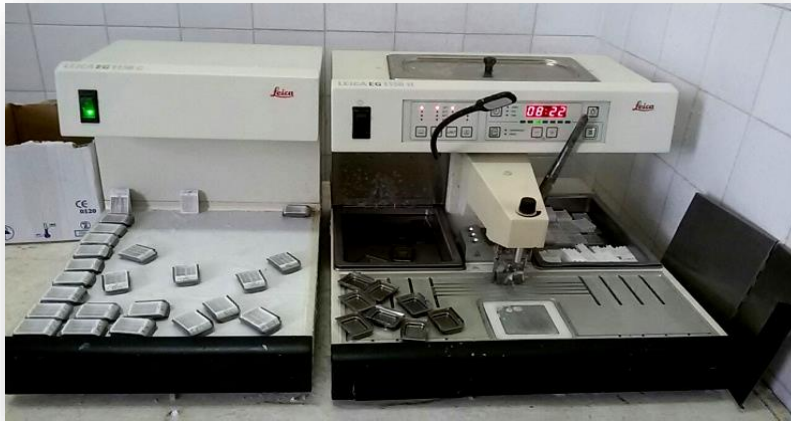
Figure02 : Automate Leica Eg 1150C. (Inclusion et paraffinage).
