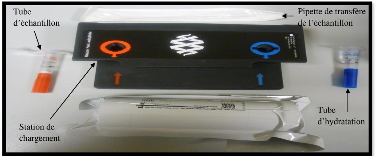
Figure 05. La station de chargement des 2 tubes bleu et rouge.
