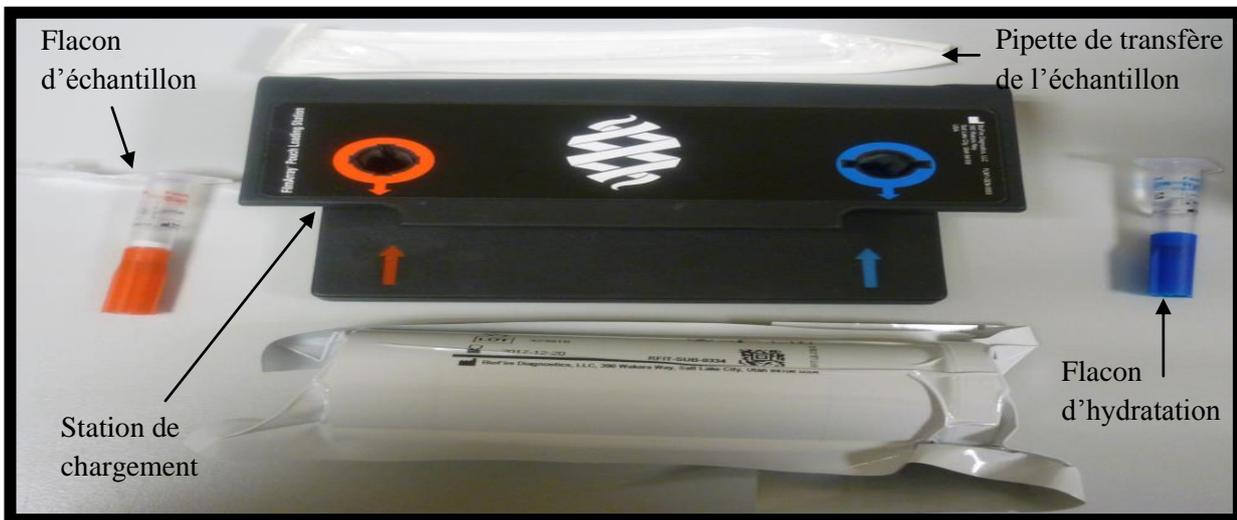
**Figure 05.** La station de chargement des 2 tubes bleu et rouge.
