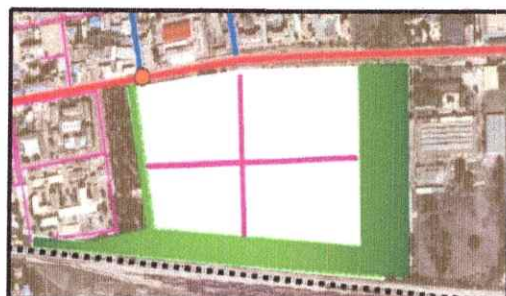
Tracé des deux axes perpendiculaires (référence aux axes matrices de la ville)
