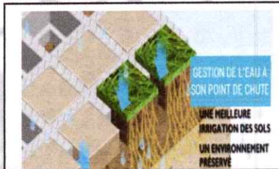
Fig 12 infiltration naturelle de l'eau pluvial
