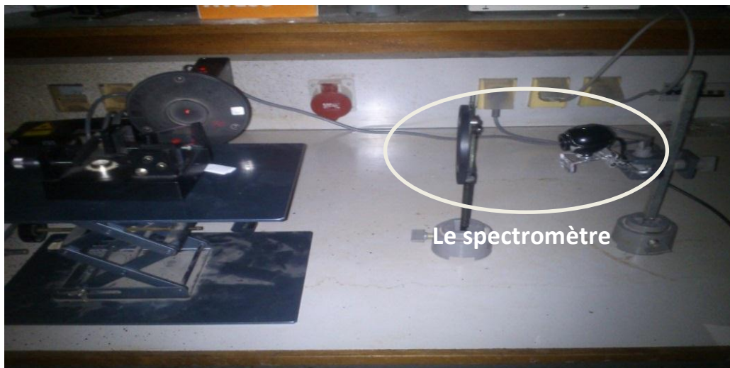
Figure 3.7. OCT à base d'un spectromètre (réseau de diffraction et une caméra)
