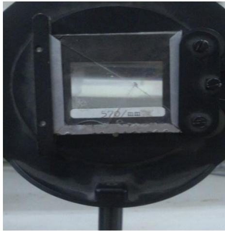
Figure 3.16. un réseau de diffraction de 570/mm.
