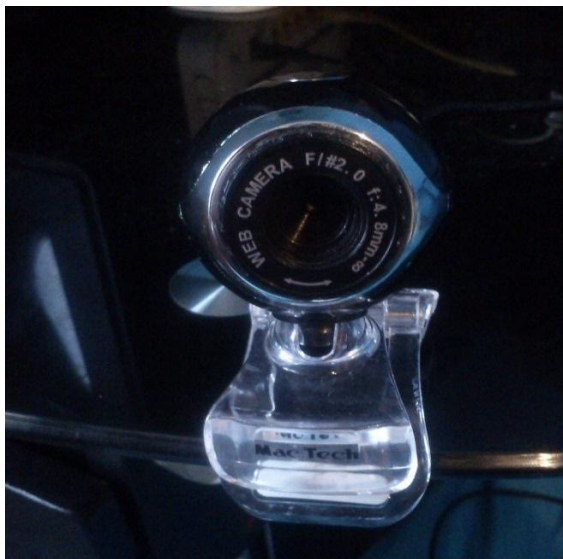
Figure 3.17.a. webcam de résolution 2.0 et Focale : 4.8mm.
