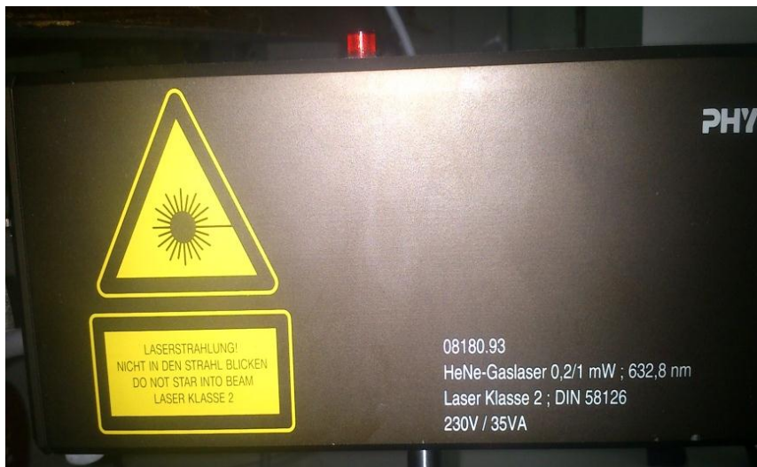
Figure 3.3. les références d'une source laser He-Ne
