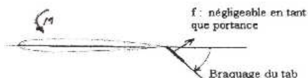
Fig (II - 10 ) Création d'un moment piqueur d'une pale
