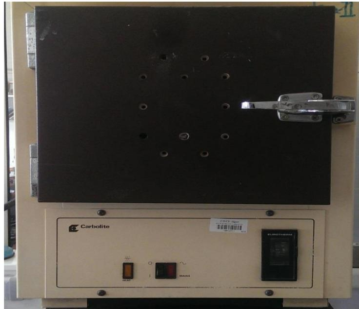
**Figure 3.11:** Cuisson le film de  $TiO_2$  dans un four de carbolite à  $400c^\circ$
