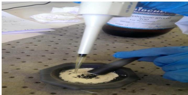
**Figure 3.6:** Préparation de la suspension de  $TiO_2$
