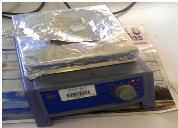
**Figure 3.10:** Echauffement de la photo-anode sur une plaquette chauffante
