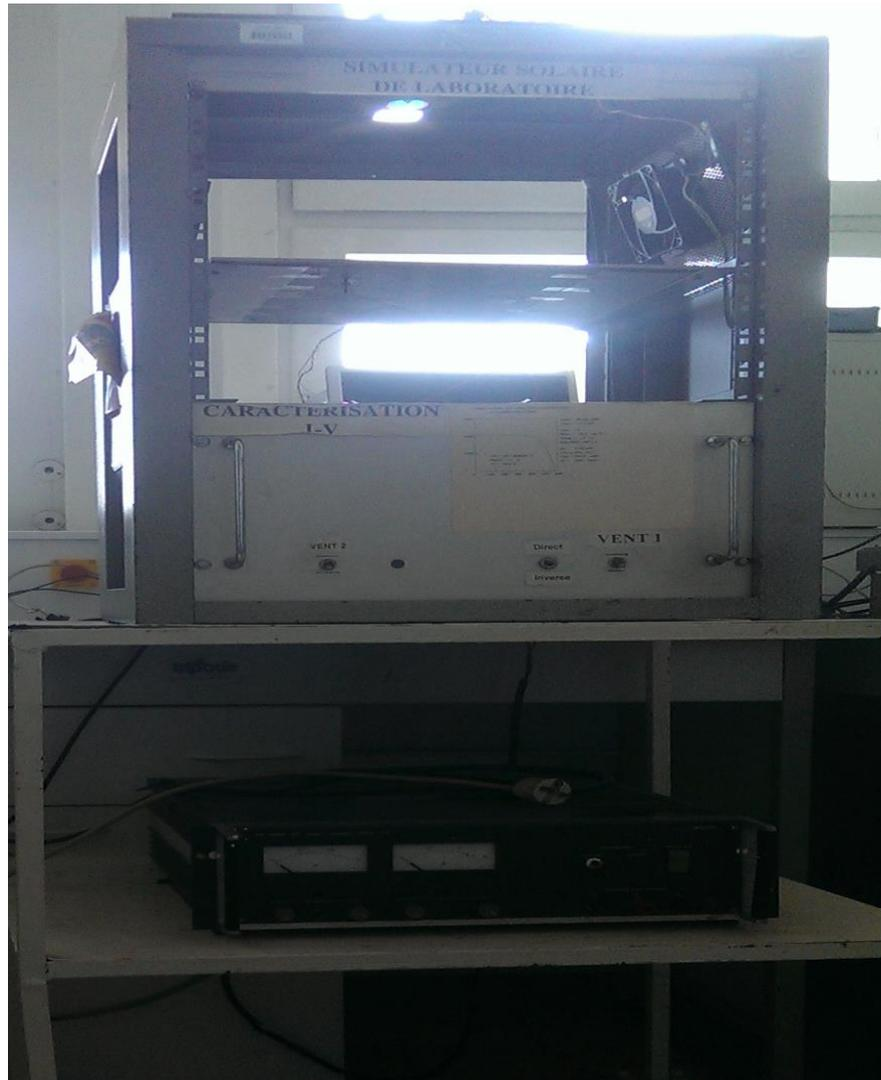
*Figure 3.20: Simulateur solaire du laboratoire CRTSE*
