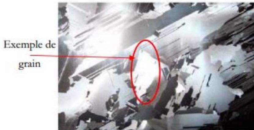
**Figure 1.13:** Photo d'un substrat de silicium poly cristallin (échelle : 10×10 cm<sup>2</sup>) [9].
