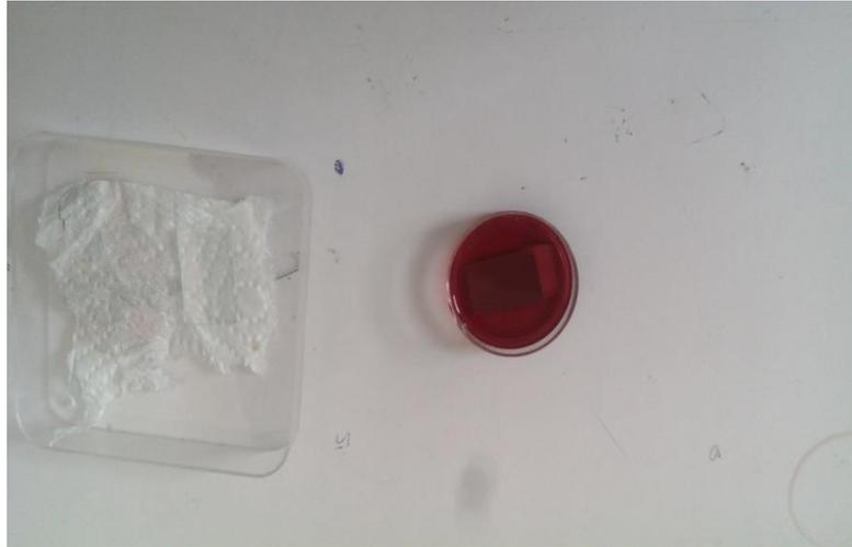
**Figure 3.12:** Sensibilisation  $TiO_2$  de par le colorant N\_719
