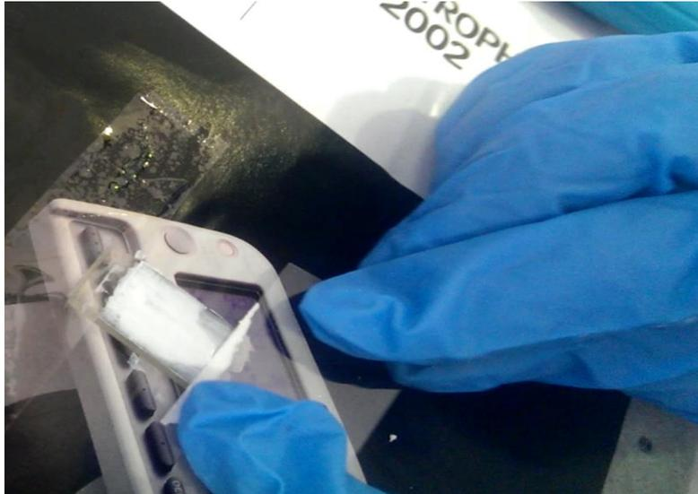
**Figure 3.9:** étalement de la pâte  $TiO_2$  sur la face conductrice de FTO
